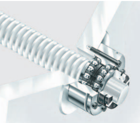
INA滚珠丝杠支撑单元的相邻结构表面需要经过表面磨铣处理。轴承座孔不需要机加工。轴承单元在安装过程中的对中通过移动驱动螺母实现
