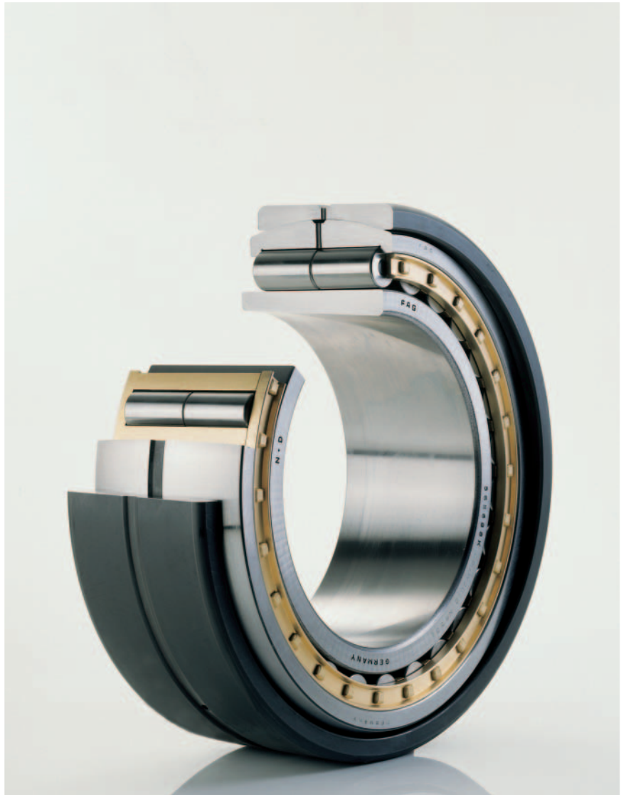
3: 自调心圆柱滚子轴承是烘缸、杨克烘缸和引导辊理想的浮动轴承。润滑槽及润滑孔开在圆柱滚子轴承和滑动轴承外圈上，便于润滑剂直接进入滚动接触区域。
