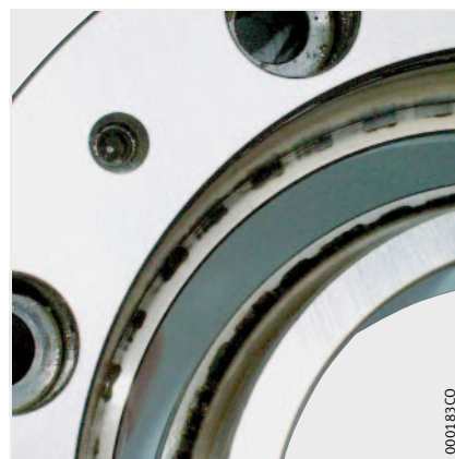
图 2: 铁/铁接触假性布什压痕导致的轴承提前失效
